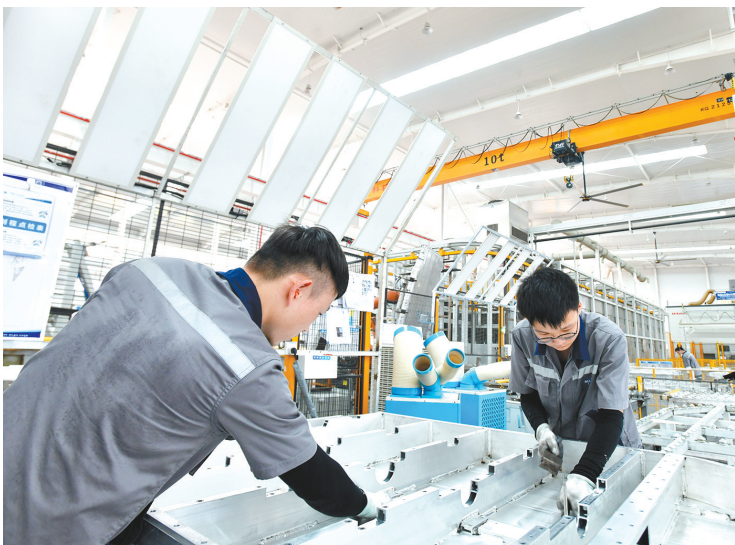
敏实新能源汽车电池盒装配。（夏正锋 摄）
