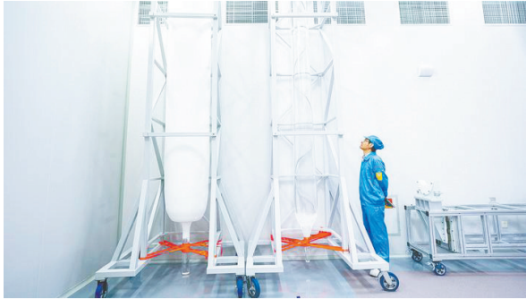
烽火通信研发生产的全球最大规格光纤预制棒。
