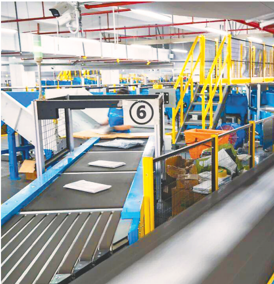
快递包裹通过传输带自动分拣。(东西湖区融媒体中心供图)
