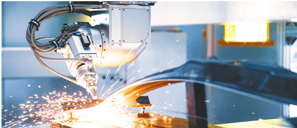
华工激光自主研发的三维五轴高端激光切割机。(本版图片除署名外均为受访单位提供)
