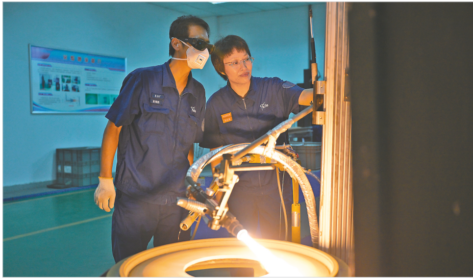
中国人民解放军第5713工厂技术与科研部特种工艺专业总师孙红梅(右)与同事讨论研究火焰喷涂工艺。(湖北日报通讯员 蒋佳慧 摄)
