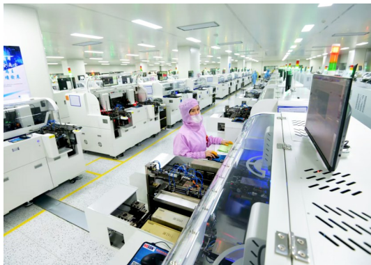
安芯美科技(湖北)有限公司,员工正在封测电子元器件,赶订单。
