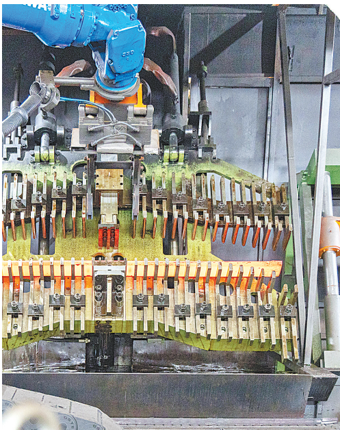
神风弹簧生产车间里，自动化机械臂抓取烧得通红的钢条进行淬火。 (湖北日报全媒记者 成熔兴 摄)
