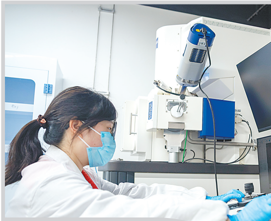
在兴发集团湖北兴友新能源科技有限公司,工作人员正通过电子显微镜观察磷酸铁。(湖北日报全媒记者 夏晓君 摄)
