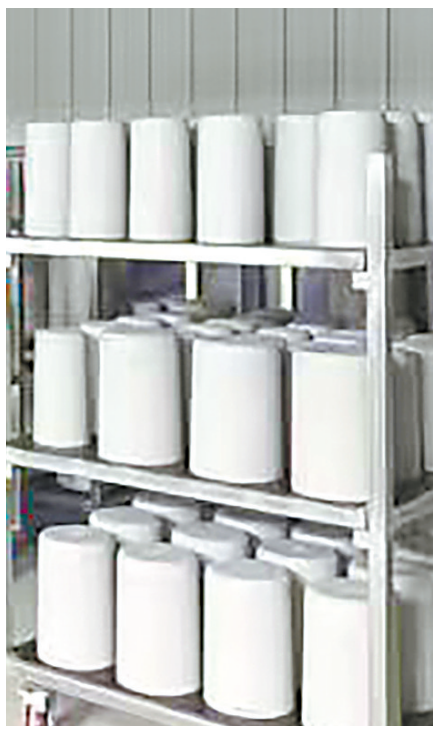
“航发功能耐火材料团队”制备的坩埚,经受千度温差而不发生脆裂。(受访单位供图)
