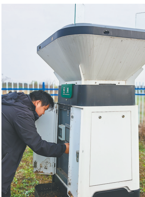
位于安陆旺鑫农业有限公司种植基地的高空昆虫灾害信息自动监测采集系统，天黑后会向千米高空射出一束光，引诱捕获趋光性害虫。
