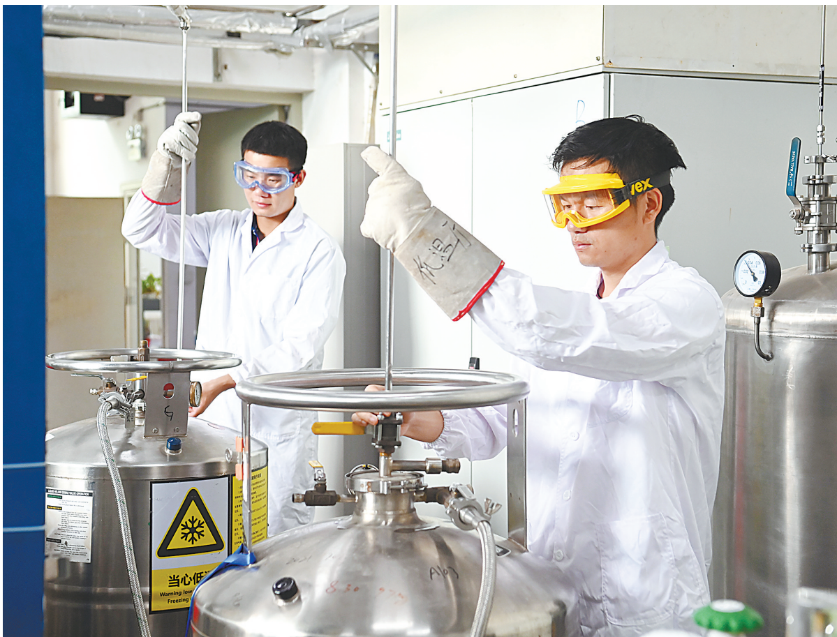
强磁场中心工作人员正在进行液氮传输。(受访对象供图)
