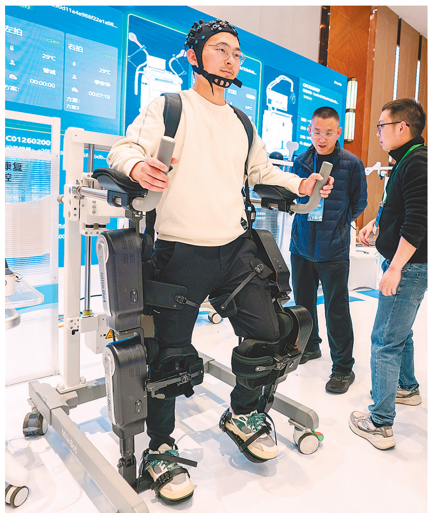
在无创脑机与神经调控新场景新产品新技术展示区，工作人员在演示脑机应用控制的下肢康复机器人。(湖北日报全媒体记者 魏铁 摄)
