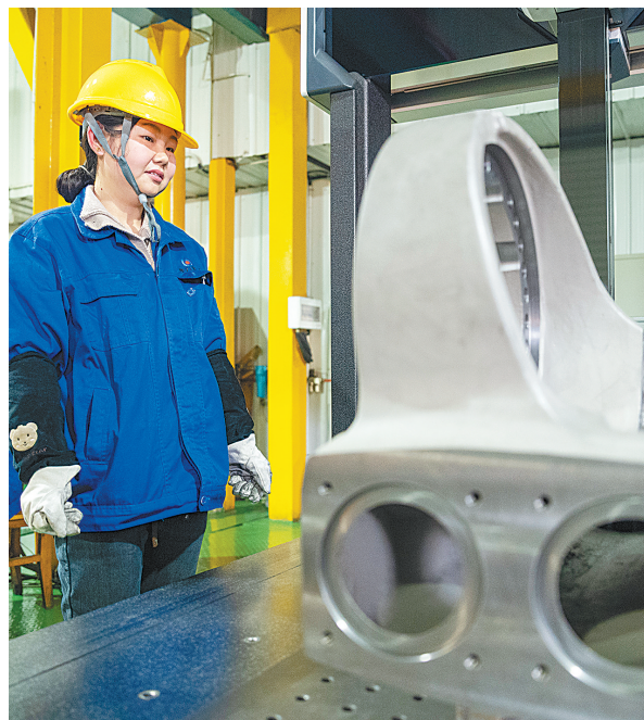
质检员操作三坐标测量机检测机器人手臂。(湖北日报全媒记者 夏晓君 摄)
