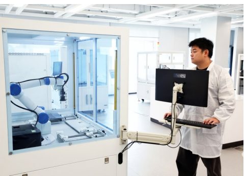
鸿蒙生态(武汉)创新中心星汉实验室内,工作人员通过六轴机械臂模拟用户的真实操作,进行人机交互测试。
