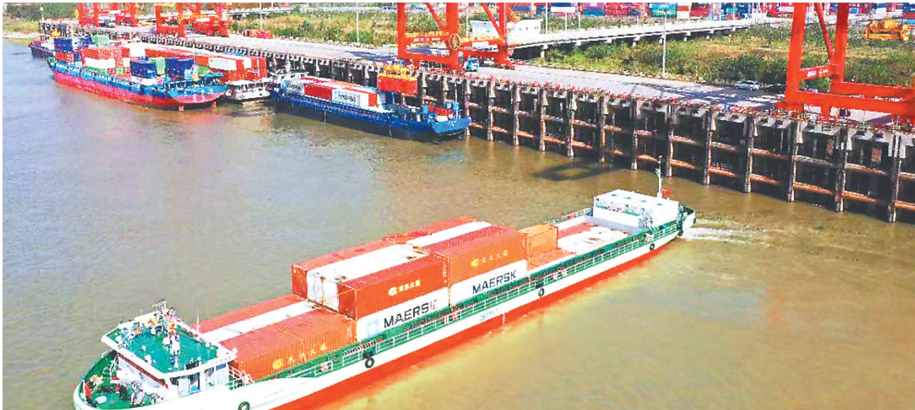
湖北长江船舶供应链公司参建的汉江首艘换电模式纯电动集装箱船——华航新能1。（受访单位供图）
