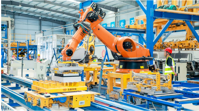
武黄改扩建项目智能化小构预制生产线。
