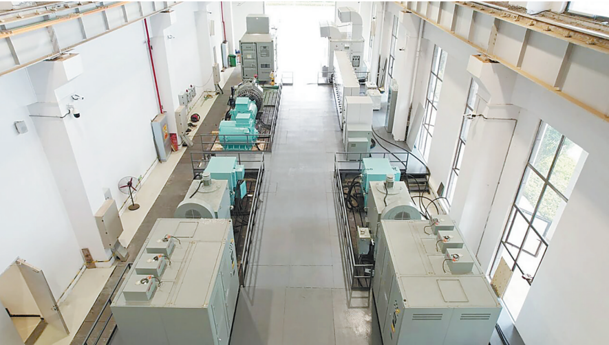
东湖实验室打造的船舶综合电力系统陆上联调试验平台。(受访单位供图)
