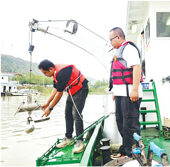
汉江局黄家港水文站悬移质输沙率测验。 (湖北日报通讯员 杨华欣 摄)
