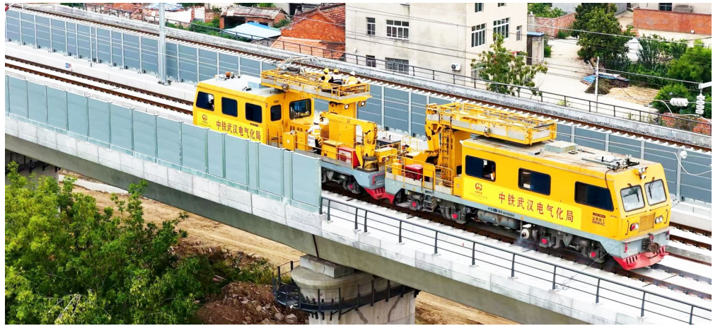
轨道车进行接触网冷滑试验。
