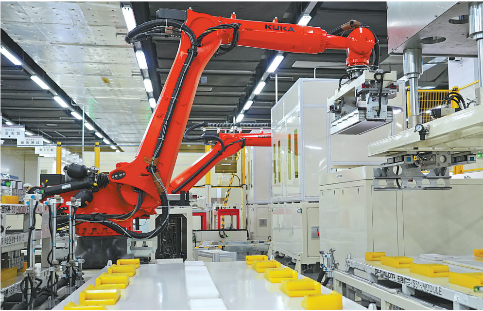
东昱欣晟生产线,机械手臂10多秒即可完成一次抓取。(湖北日报全媒记者 刘路 摄)
