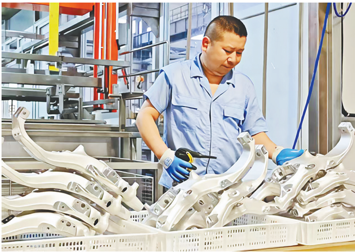
工作人员检查新能源乘用车转向节的整洁度。(受访单位供图)
