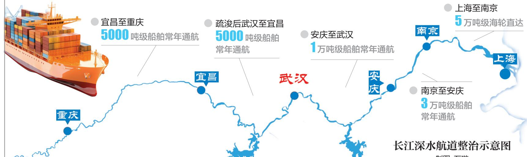
湖北日报讯（记者高伊洛、通讯员李清贵、谭梦瑶）8月20日上午，随着长鹰8、鄂众港浮002轮等5艘疏浚船舶进驻枝江水道和江口水道，2025年长江干线宜昌段航道维护疏浚项目正式开工。预计工程完工后，长江宜昌至武汉段航道枯水期维护水深将全部提升至4.5米，5000吨级船舶可满载畅行武汉至重庆。
