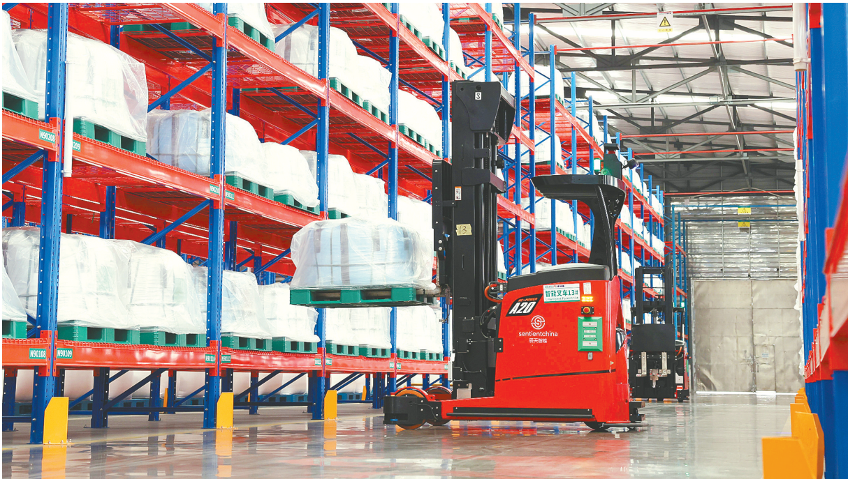
近日,荆门市掇刀区格林美AGV智能仓储区内,智能叉车精准完成扫码、抓取、移送等动作,成品入库全程无人介入。
