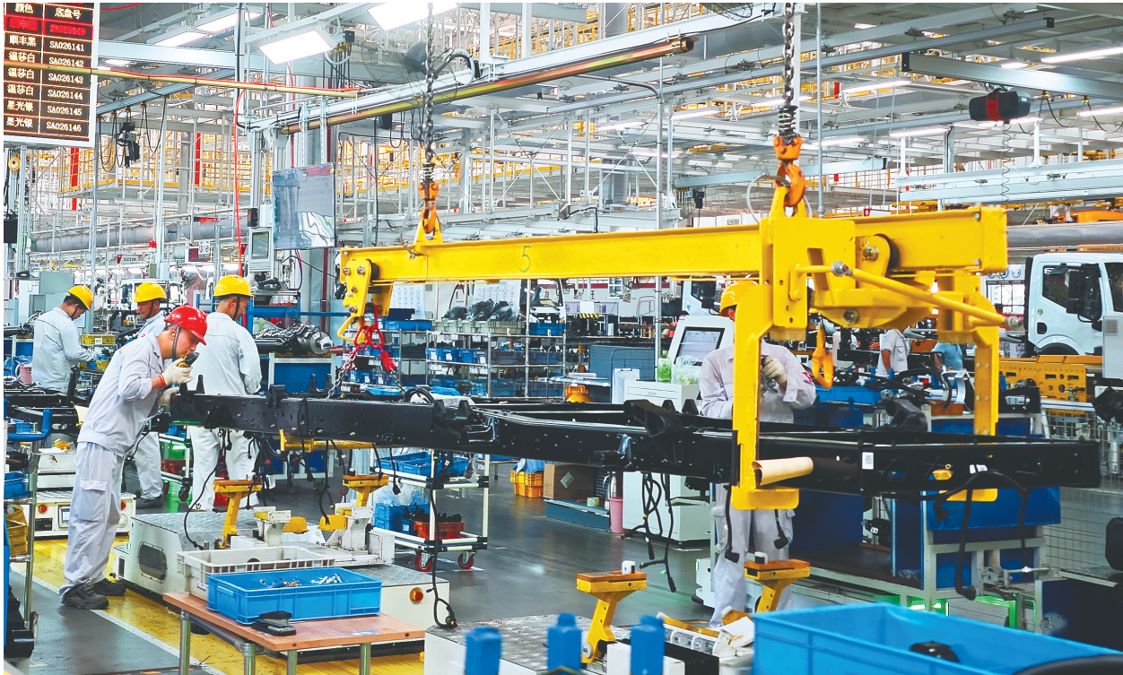
AGV智能搬运机器人将零件送到工位。(湖北日报全媒记者 杨然 摄)
