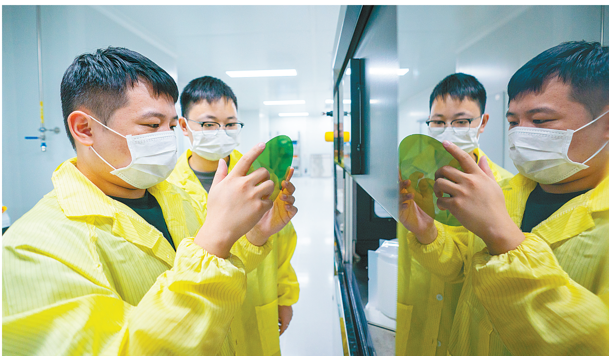
7月21日，硅来半导体（武汉）有限公司洁净室，工程师检查完成切片、研磨的碳化硅晶圆。（湖北日报全媒记者 魏铤 摄）
