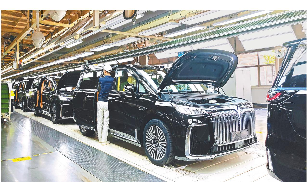
等4种车型共线混流生产,还能满足上万种不同配置车型随机生产,只需118秒,就有一台车下线。
