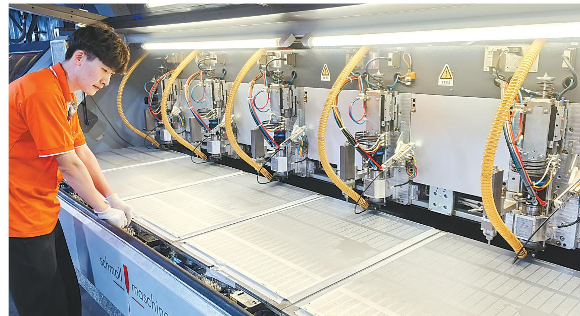
黄石市名扬纪涵电子有限公司工人操作线路板钻孔机。(湖北日报通讯员 胡川 摄)
