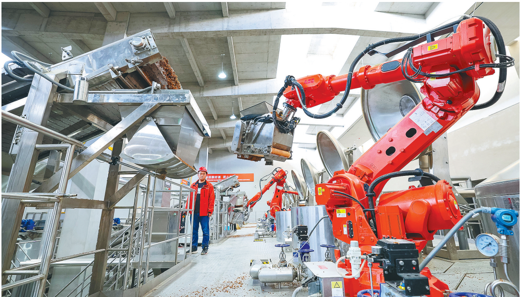
上甑机器人正在作业。（湖北日报通讯员 杨东 摄）
