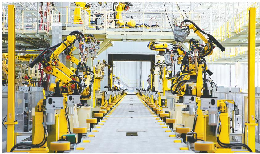
装焊生产线上，机器人正在联调联试。
