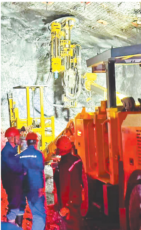
自动锚杆台车，实现矿井顶部锚杆支护自动化机械作业。（湖北日报全媒记者 张乐克 摄）
