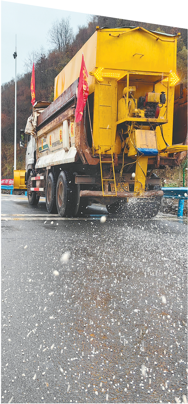
湖北交投鄂西北运营公司客货管理所撒布机正在进行融雪剂撒布作业。 (湖北日报通讯员 金伟忠 贺永 姜谷平 摄)
