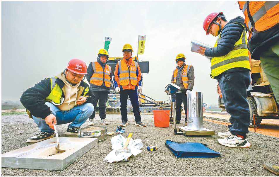
2024年12月27日，武松高速江陵至松滋段，中铁十一局建设者为道路摊铺做压实度试验，确保今年9月完工。
