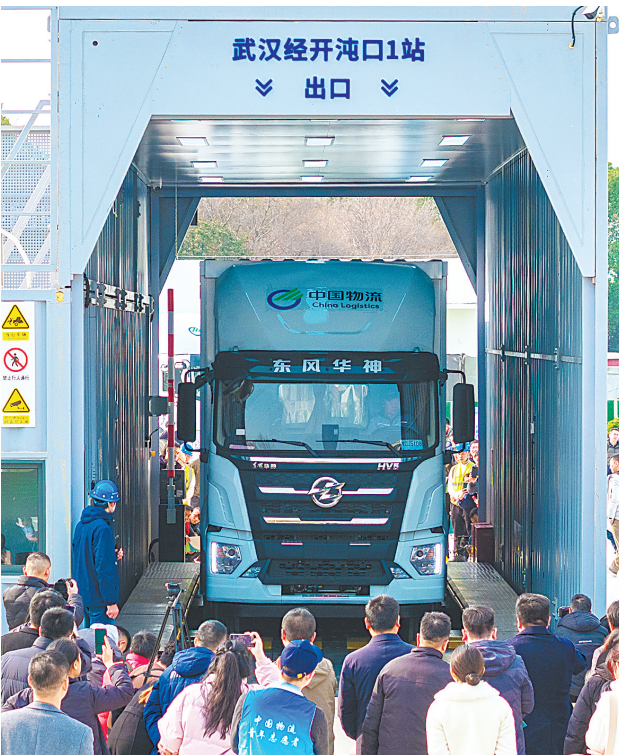
图为现场一辆纯电重卡展示了动力电池快速更换的过程，将原本需要一个多小时的充电时间缩短至5分钟。
