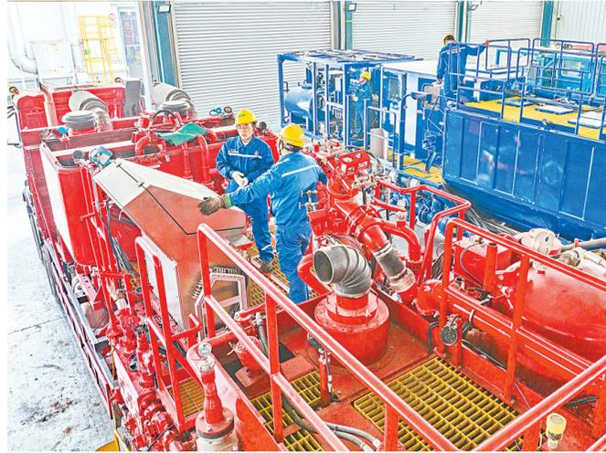
1月6日,荆州四机赛瓦公司技术人员组装生产海洋固井装备。该公司研制的防爆双机双泵固井橇组作为核心作业装备,助力中国首艘超深水大洋钻探船“梦想”号建造成功。(湖北日报全媒记者 刘曙松 通讯员 肖敏 摄)
