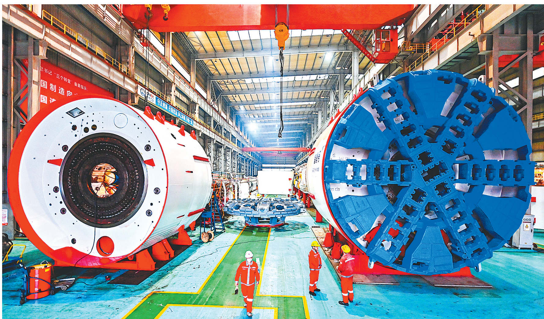
12月12日,在中铁科工江夏基地,工人正在调试下线的双模盾构机“智勇号”。(湖北日报全媒体记者 朱熙勇 通讯员 胡鹏 摄)
