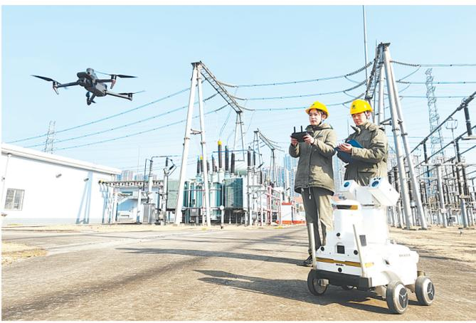
11月25日,国网武汉供电公司工作人员利用无人机、轮式机器人,在巡司河变电站开展立体巡视检查。(国网武汉供电公司)
