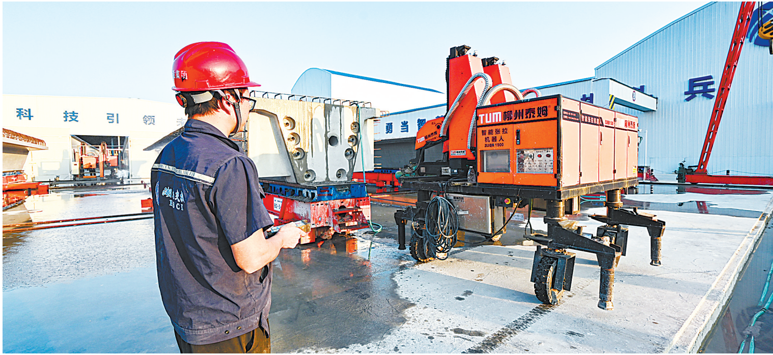
武天高速智慧梁厂的智能张拉机器人。(湖北日报通讯员 吴迪 摄)
