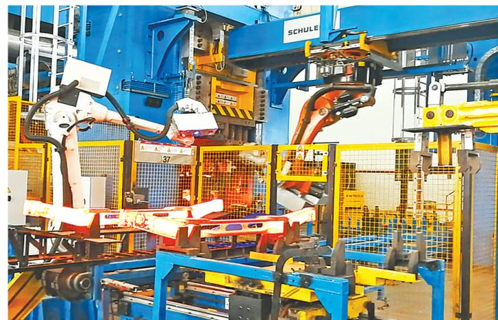
惟景三维测量设备正在扫描测量生产线上的零部件尺寸。(受访单位供图)
