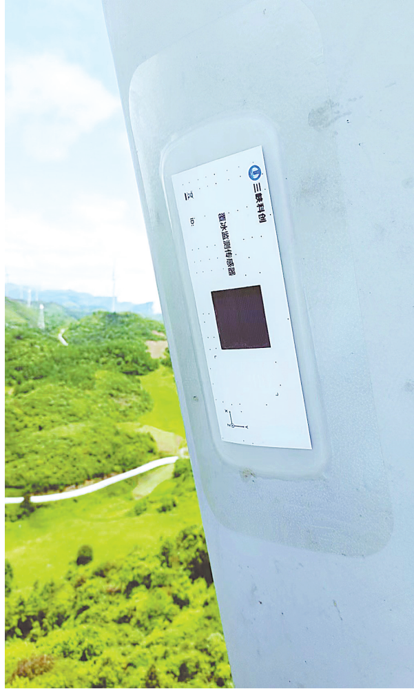
贴在风机叶片上的“柔性覆冰监测传感器”。 (受访单位供图)
