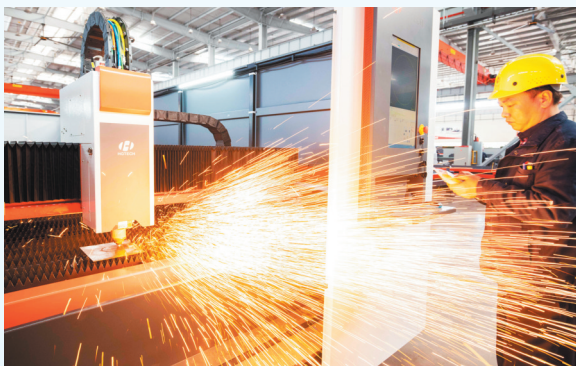
技术人员在华工科技智能制造产业园(葛店园区)调试激光设备。
