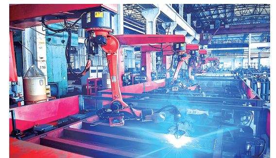
位于江夏区的武汉科迈机械制造有限公司的车间里,湖北首条铁路车柔性端墙机器人焊接生产线。
