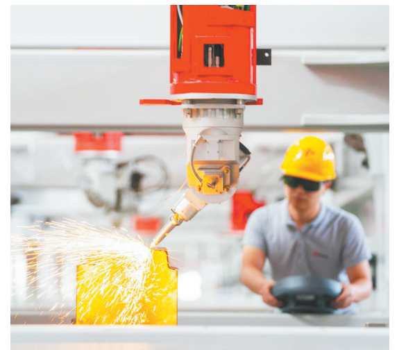
华工科技智能装备产业园(葛店园区),在国内最大的三维五轴激光切割机产线上,工作人员正加紧组装、调试订单设备。
