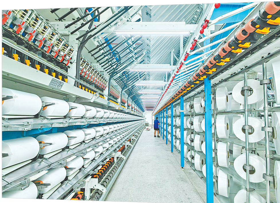
在三圆纺织生产线上,化纤原料经加弹机定型,制成高性能涤纶丝。(湖北日报全媒体记者 肖杨 摄)
