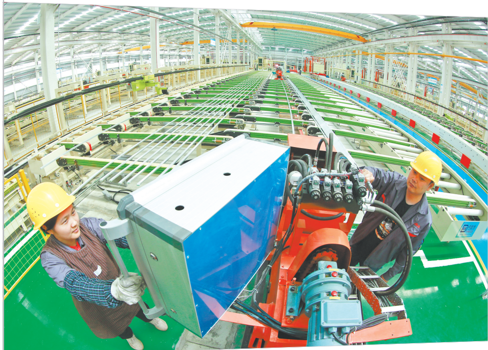
立铭铝业的员工在铝型材挤压生产线上操作。(湖北日报通讯员 刘银斌 摄)
