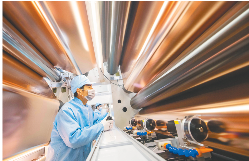
黄石诺德锂电铜箔产业园,一台台生箔一体机正高效运转,工作人员有序操作设备生产。(湖北日报全媒体记者 薛婷 通讯员 周晓达 摄)
