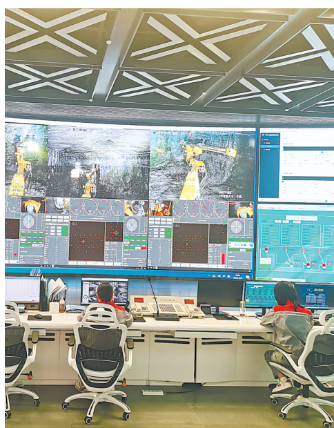
工人指挥井下智能凿岩机器人作业。(湖北日报通讯员 牟海军 乔长娇 摄)
