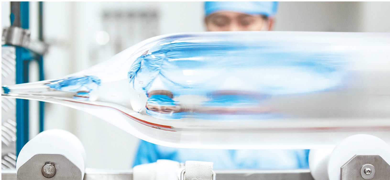
长飞光纤工作人员在检测光纤预制棒。(湖北日报全媒体记者 柯皓 摄)
