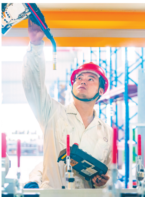
员工在湖北精确新能源科技有限公司新能源汽车锂电池盒产线上调试焊接机器人。(湖北日报全媒记者 魏铤 摄)
