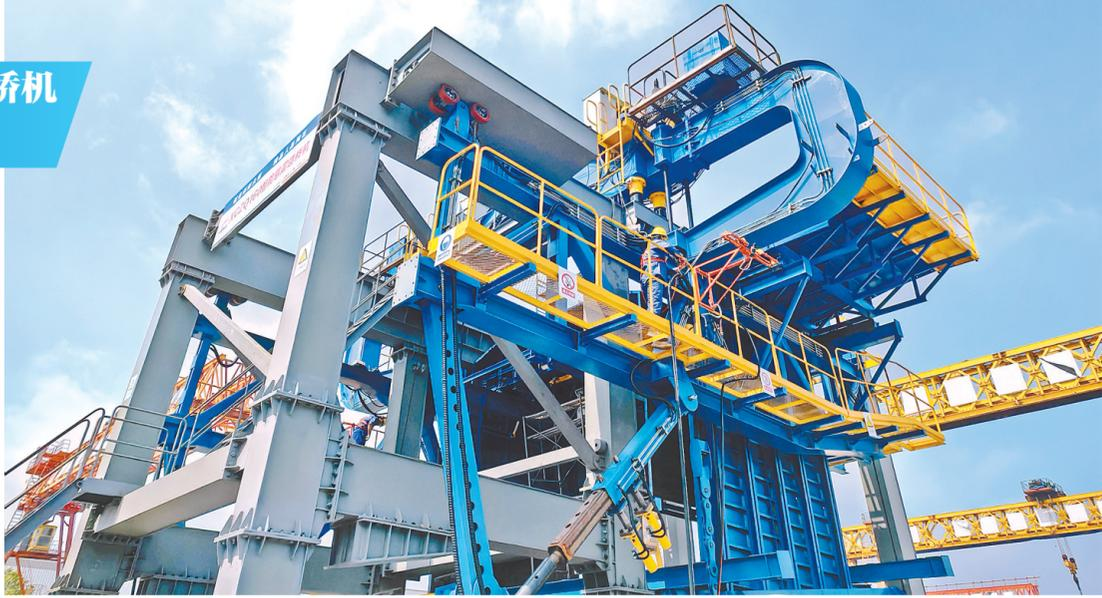
7月3日,汉江重工(襄阳)设计制造的新型智能悬灌造桥机进行技术调试。该造桥机可实现造桥过程中钢筋笼整体入模,钢筋绑扎与节段梁浇筑养护并行作业,施工全过程自动化程度高,人员操作安全且劳动量小,目前在全国处于领先水平。
