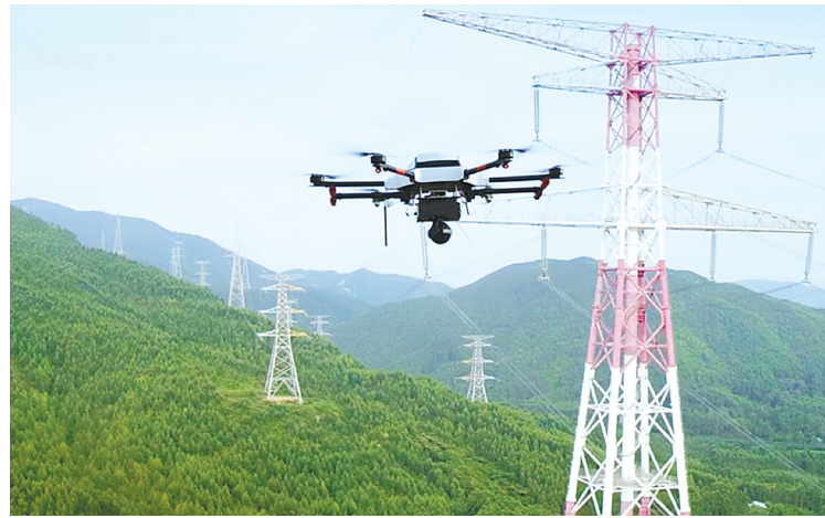
无人机自主巡视电网的精度可达到厘米级。(受访单位供图)
