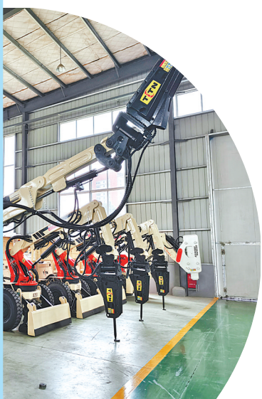
湖北天腾重机车间内,一台新组装的撬毛台车整装待发。(湖北日报全媒体记者 张诗秋 摄)
